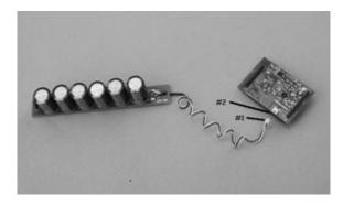
BEFORE YOU INSTALL THE RECEIVER IN THE LOCOMOTIVE, PLUG IN THE MALE PLUG FROM THE CAPACITOR BOARD MARK #1 TO THE FEMALE PLUG MARK #2 ON THE RECEIVER.
